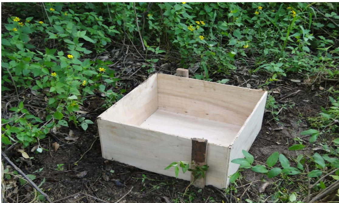
Figura 3 – Caixa coletora de sedimentos instalada na planície de inundação (Fonte: ESFS - 2009)
