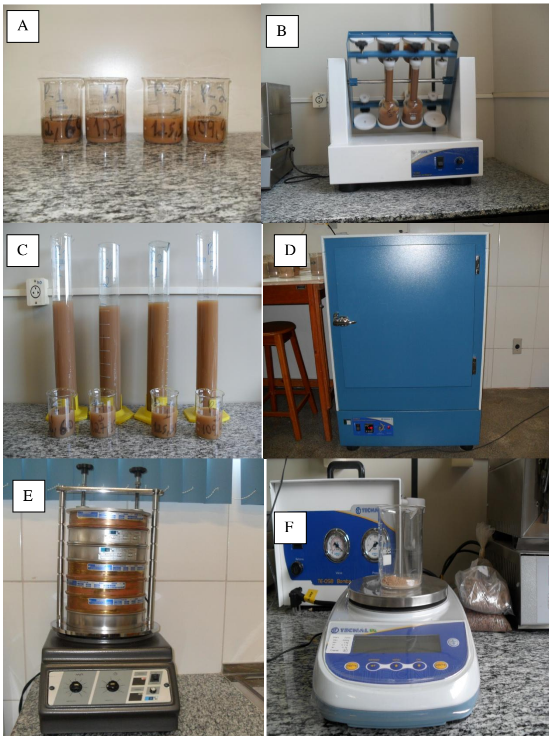
Figura 05: Etapas para análise de Pipetagem (dispersão total) no Laboratório de Pesquisas e Estudos em Geomorfologia Fluvial (LAPEGEOF): (a) Becker; (b) Agitador de Wagner; (c) Provetas; (d) Estufa; (e) Agitador de Peneiras; (f) Balança de Precisão Fonte: SILVA, 2011
