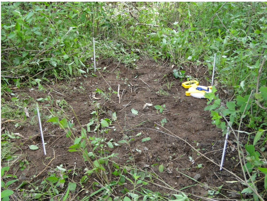
Figura 04 – Pinos para monitoramento de sedimentação na planície (Fonte: ESFS - 2009).
