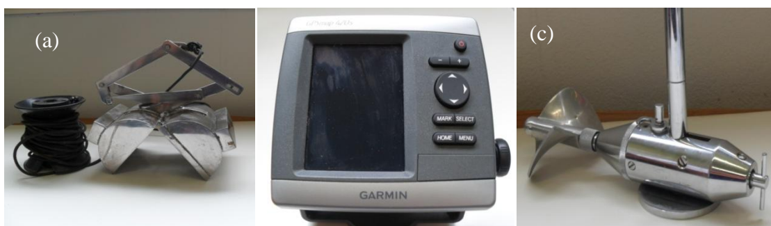
Figura 02: (a) Draga Van Veen para coletas de sedimentos de fundo (b) Sonar garmin GPSMAP 420S para determinação de largura e profundidade (c) Molinete fluviométrico para determinação de velocidade do fluxo Fonte: ANDRADE, 2010.
