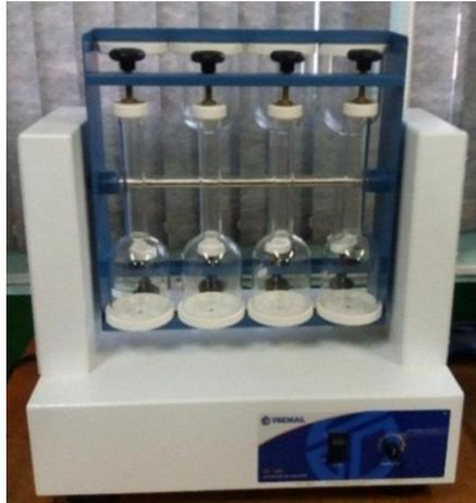
Figura 10 – Provetas com sedimentos para pipetagem
