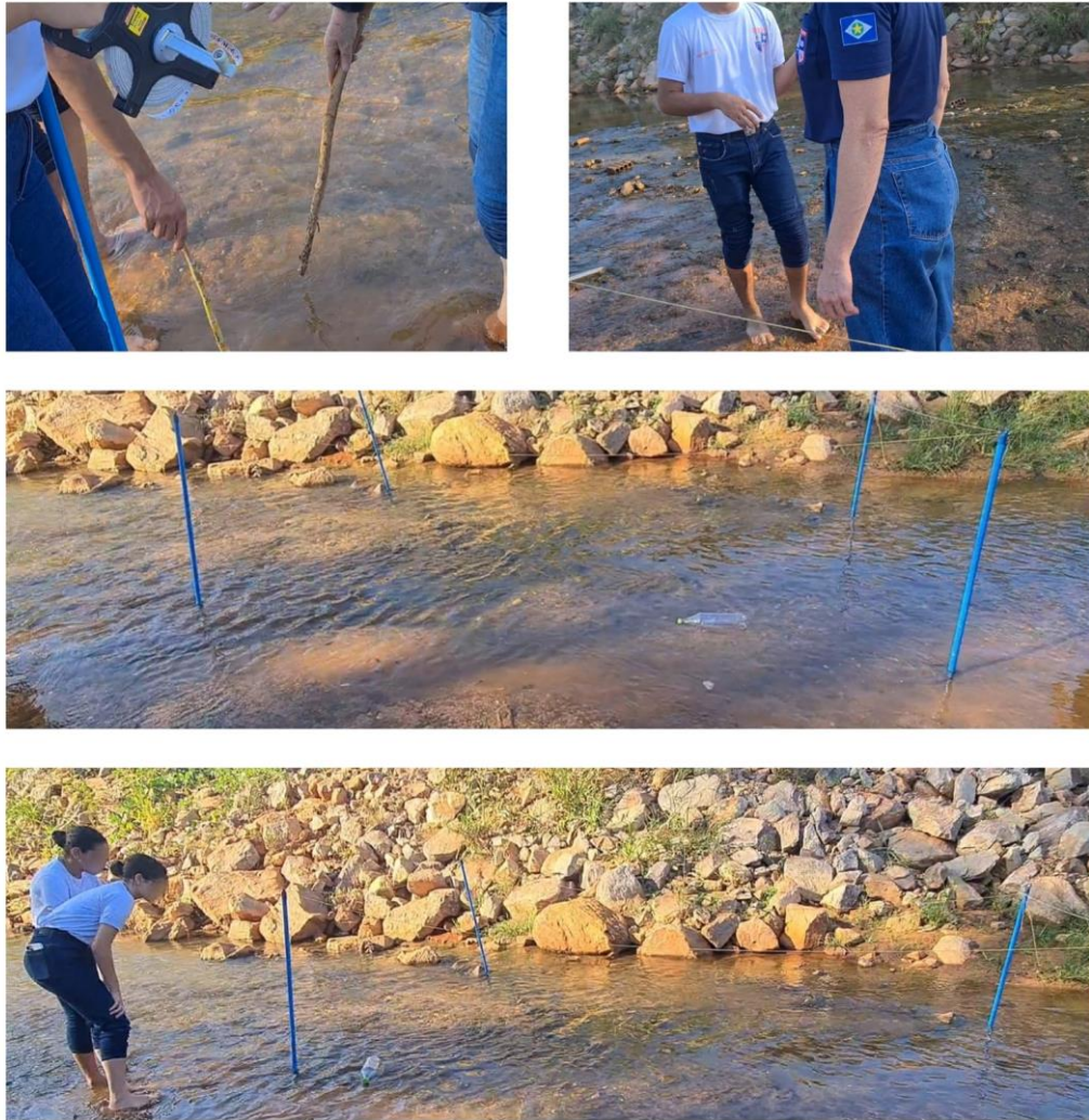
Figura 9 - Estudantes realizando a medição da vazão de água do córrego Buriti.
