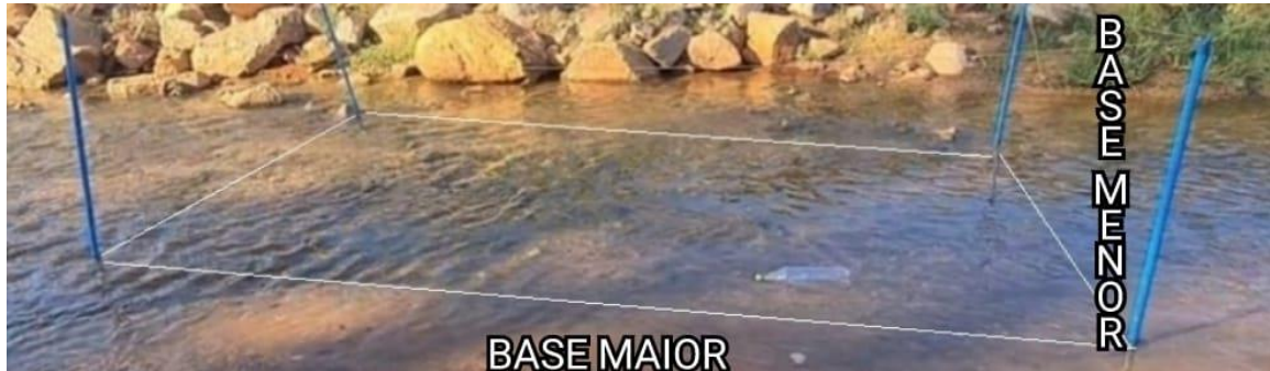
Figura 10 - Estudantes delimitam um paralelepípedo na água no córrego Buriti para o cálculo da vazão de água.
