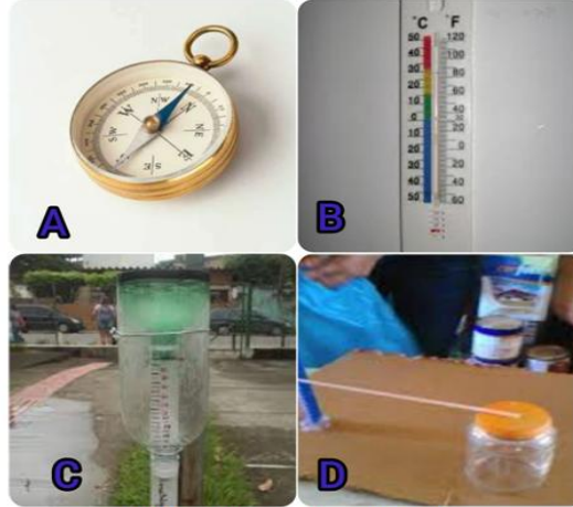
Figura 02 – Instrumentos didáticos para aulas de geografia: A) Bússola. B) Termômetro de mercúrio. C) Pluviômetro. D) Barômetro.
