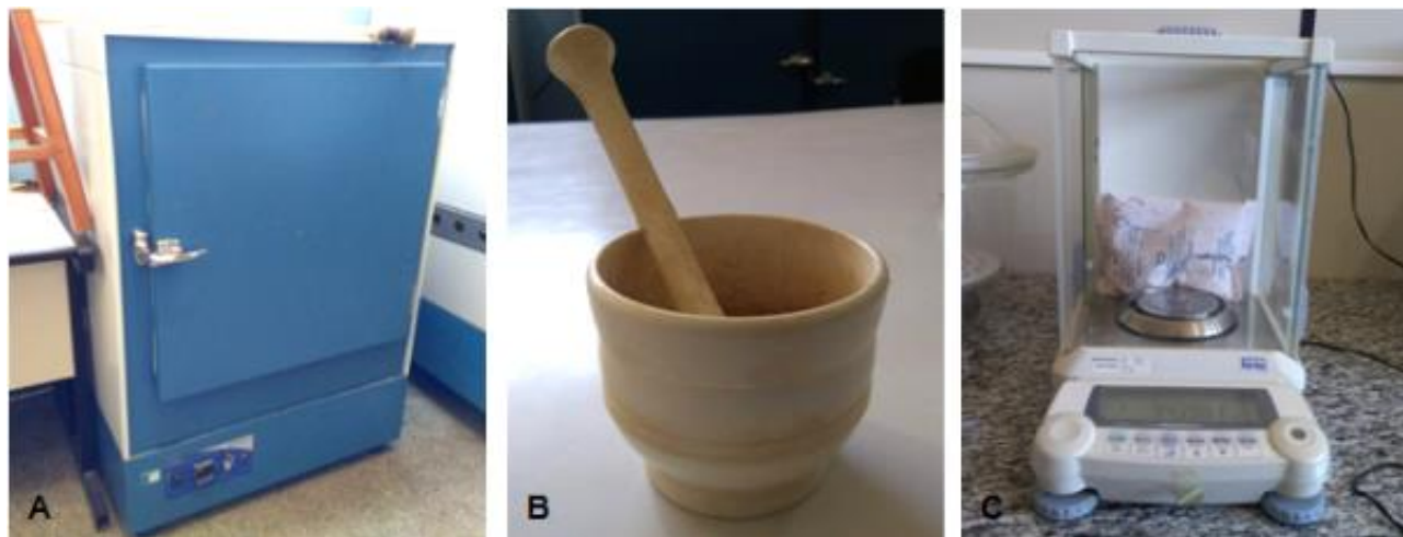
Figura 10 - (A) Estufa TE–394/2; (B) Cadinho e pistilo; (C) Balança analítica
