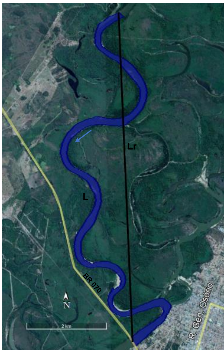
Figura 13 – Base para o Índice de Sinuosidade do canal principal
