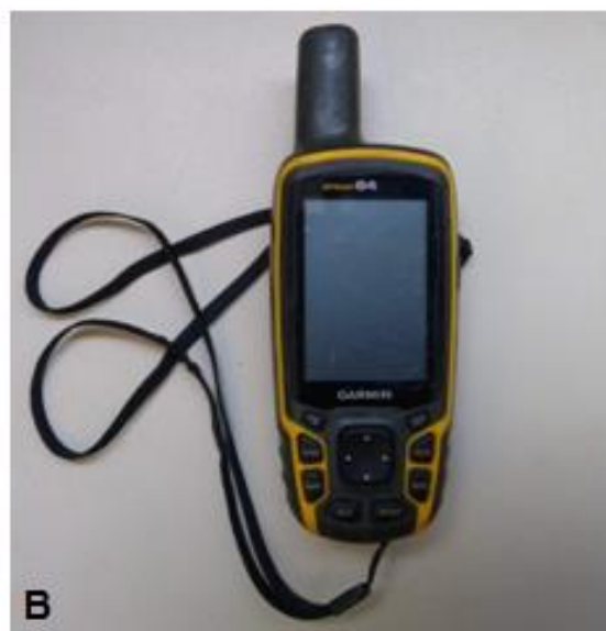
Figura 06 - (A) Ecobatímetro GARMIN echo 301c . (B) GPS GARMIN map 64
