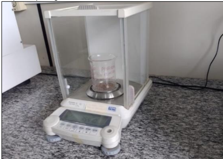
Figura 5. Etapa de pesagem dos sedimentos amostrados em trabalho de campo.
