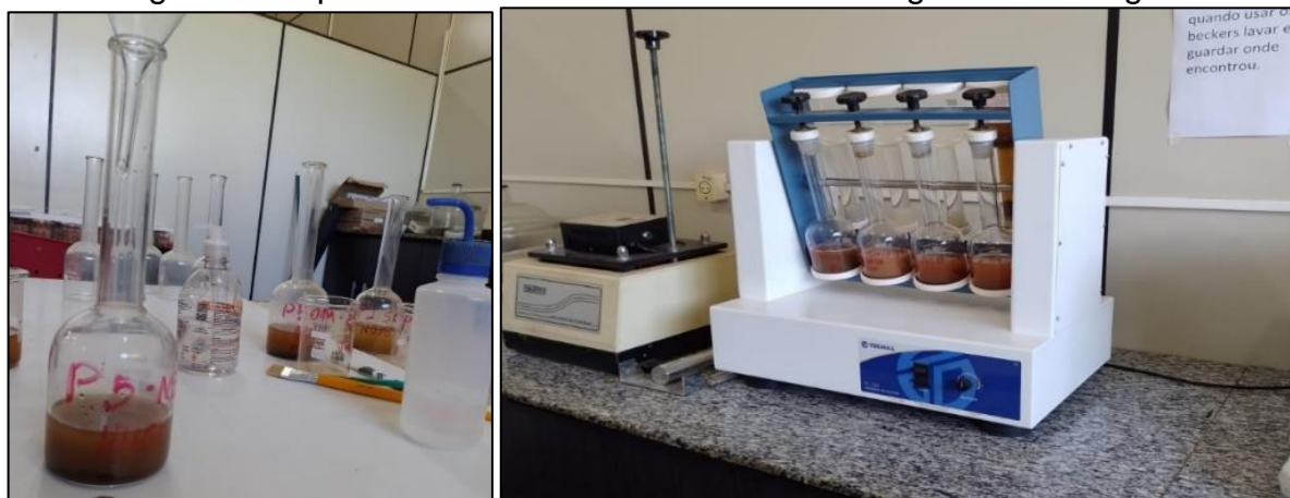
Figura 4. Dispersão das amostras com auxílio do agitador de Wagner.
