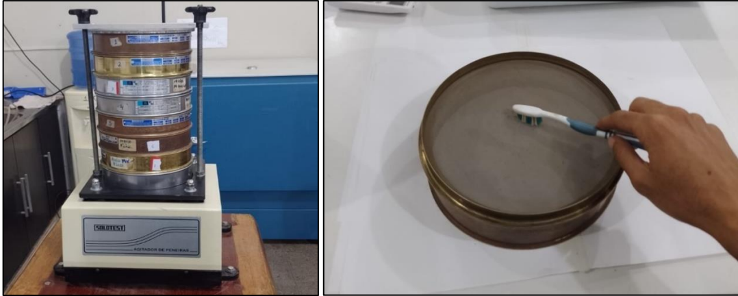
Figura 6. Agitador de peneiras utilizado para a separação e classificação granulométrica.
