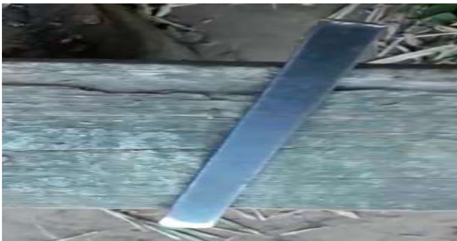
Figura 12 – Talhadeira utilizada para confeccionar pilão
