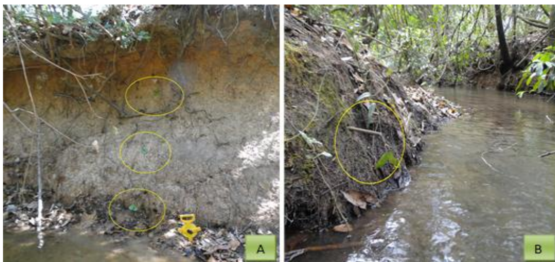
Figura 41 - Pinos de ferro para monitor a erosão marginal do córrego Salobra, Porto Estrela, MT.
