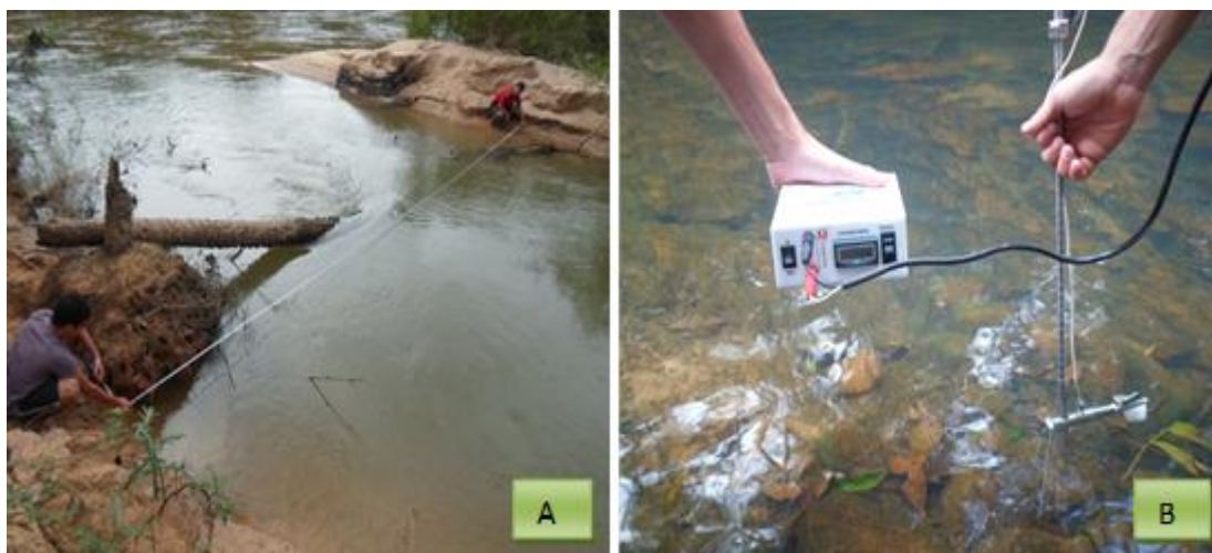
Figura 40- (A) Verificação da largura do canal e velocidade da água, (B) Molinete hidrométrico para medir a velocidade da água.
