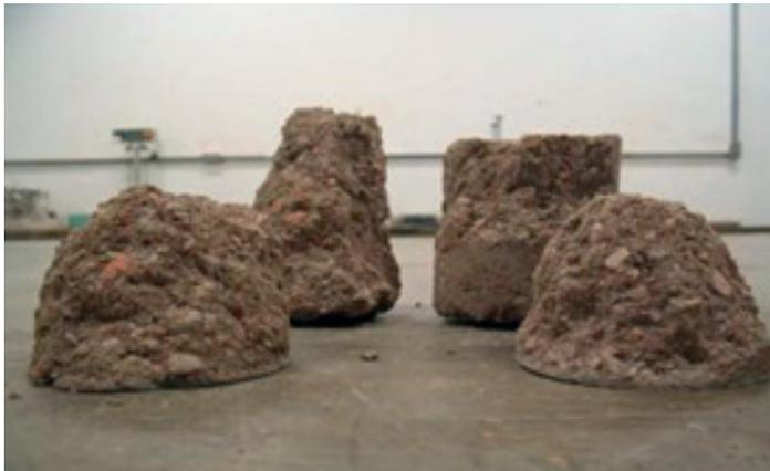
Figura 7 – Corpos-de-prova de rejeito após ensaio de compressão axial.
