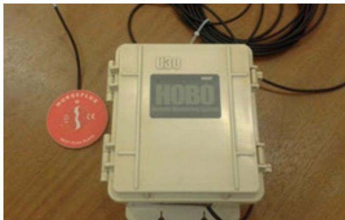
Figura 04 - Fluxímetro da Hukseflux e data logger da marca HOBO.
