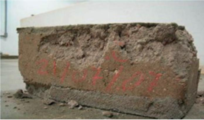
Figura 6 – Tijolo do rejeito após ensaio de compressão axial.
