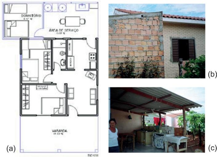
Figura 07 – Casa 06 na cidade de Itiquira: a) planta baixa com ampliações; b) foto da lateral ampliada e mudança de posição da janela; c) foto da ampliação da varanda nos fundos da edificação.
