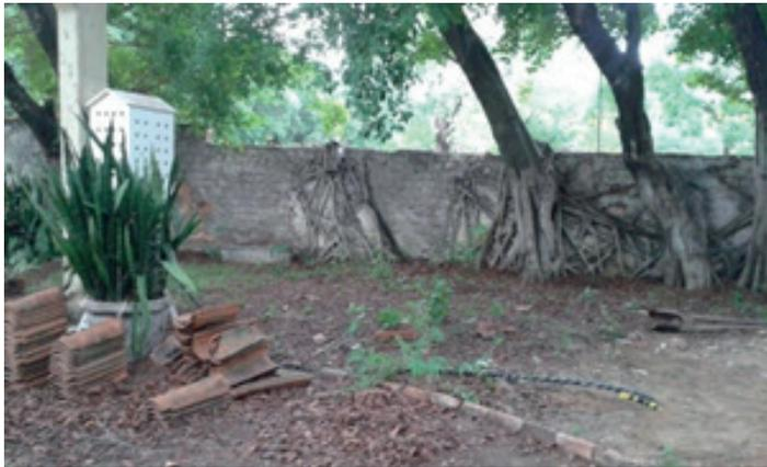
Figura 02 - Estação de medição de temperatura e fluxo de calor no solo com superfície sombreada.
