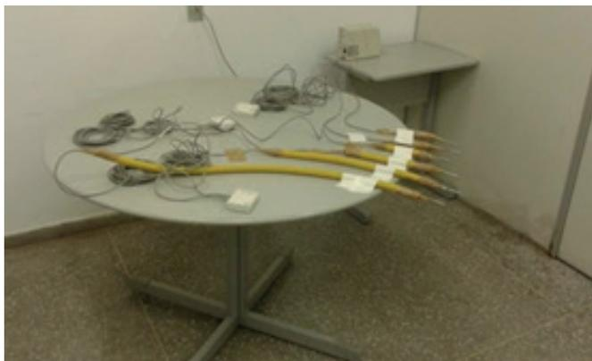
Figura 03 - Conjunto de termistores e respectivos data loggers da marca HOBO usado na caracterização do perfil de temperaturas do solo.
