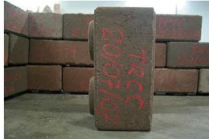
Figura 2 – Tijolo do rejeito da construção civil.
