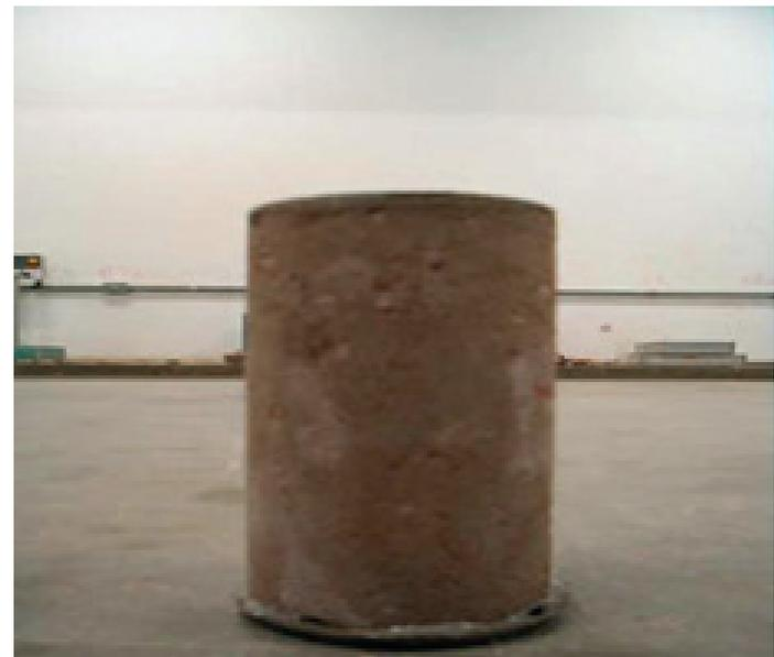
Figura 3 – Corpo de prova do micro-concreto do rejeito.
