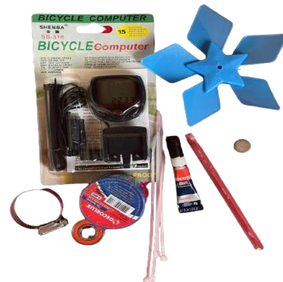
Figura 7 – Materiais para construção do molinete hidrométrico (Fonte: Próprio autor).
