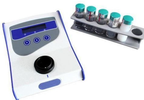
Figura 5- Ilustração esquemática de um turbidímetro de bancada (MS Tenopon).
