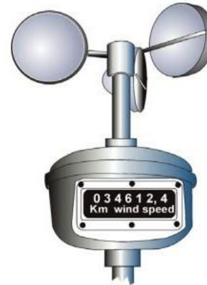
Figura 10 – Anemômetro (Fonte: VAREJÃO-SILVA, 2016).
