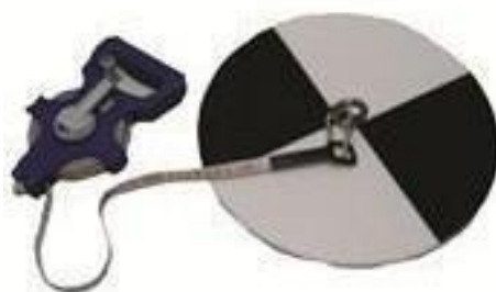
Figura 6 - Desenho esquemático do disco de Secchi sendo utilizado em campo (Hexasystem).
