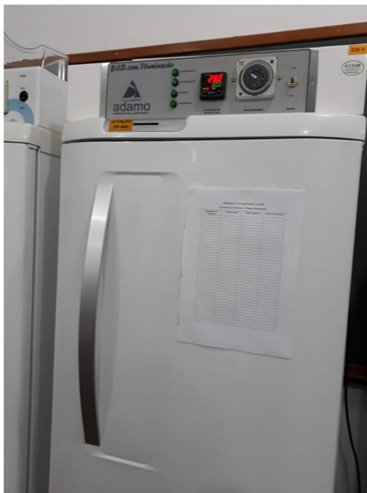
**Figura 5** - Câmara de germinação onde foi conduzido o teste de germinação das sementes de *Parkia pendula* após os testes de envelhecimento acelerado e de condutividade elétrica
