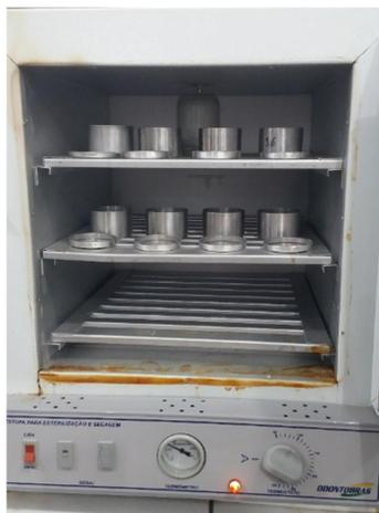
**Figura 2** - Estufa de secagem das sementes de *Parkia pendula* submetidas ao teste de envelhecimento acelerado
