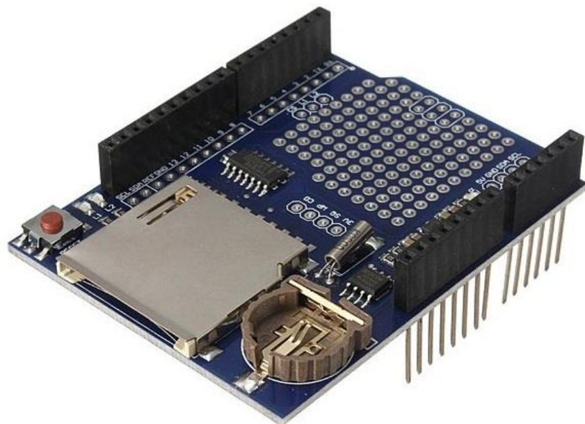
Figura 5 - Ilustra o Data Logger Shield com RTC DS1307. Fonte: Filipe Flop, 2021.
