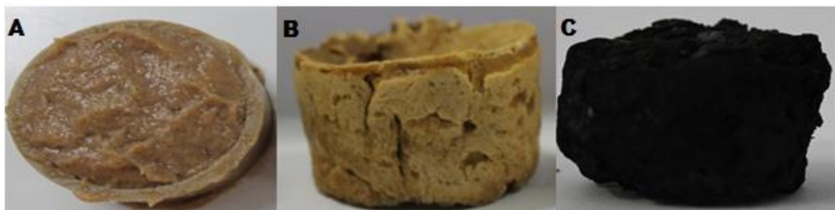
FIGURA 2 Massa de polpa da banana madura em molde cilíndrico de PVC (A); Briquete precursor seco (B); Briquete de carvão (C)
