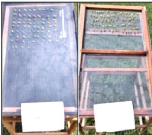
Figura 1. Amostras  $A_1$  e  $A_2$  de pimentas, no experimento dentro do secador solar e colocadas diretamente ao Sol.
