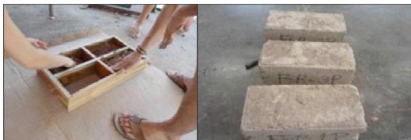
Figura 3. Deposito da massa dos tijolos na forma.
