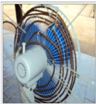
Figura 1. Tubo de cobre enrolado no motor.
