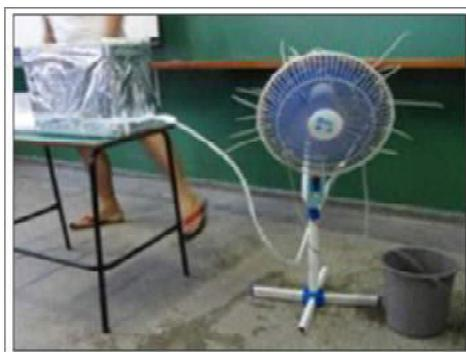
Figura 4. Esquema de montagem do refrigerador de ambiente.
