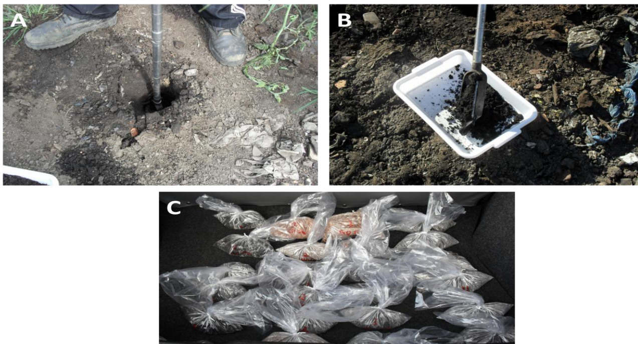
Figura 3- Coleta das amostras de solo; A- perfuração com o trado holandês; B- coleta da amostra; C- Acondicionamento e identificação das amostras.
