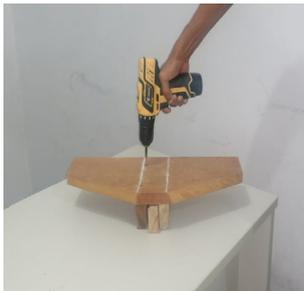
Parafuse as ripas na madeira, deixando um espaço para passar uma tábua (dica 1: coloque 3 ripas juntas e parafuse apenas as das laterais; dica 2: marque no lado que for parafusar duas linhas para ter como guia na hora de parafusar.
