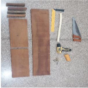
2 tábuas de 0,50x0,20cm, 1 tábua com mais de 0,70cm, até 2m x0,20cm, 4 ripas de 0,20cm, 1 bastão de madeira de 1 polegada de diâmetro com 0,50 de comprimento (pode ser utilizado um galho de árvore), 8 parafusos com 6 cm de comprimento, serrote, esquadro, lixa chave de fenda ou parafusadeira.
